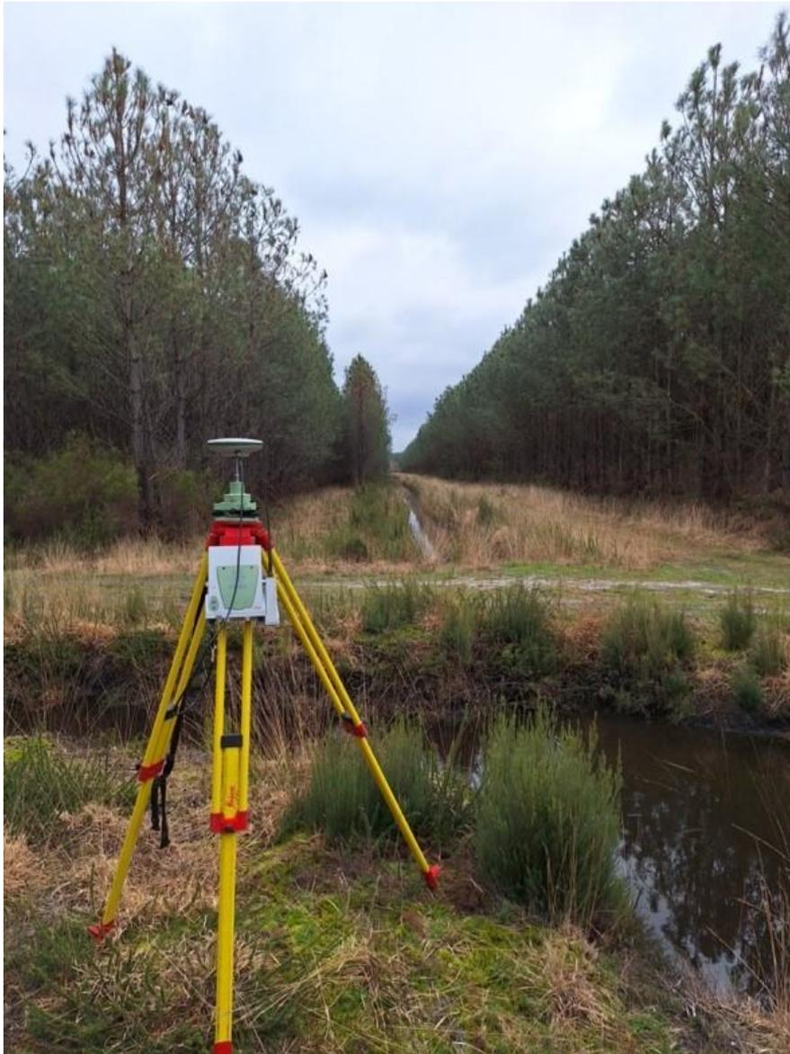
*Figure 16 : Base du DGPS différentiel utilisé pour le nivellement à Sescousse*
