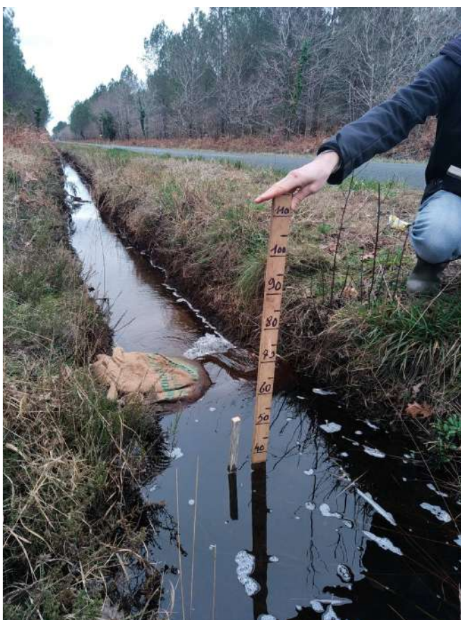
Suivi lors des crues de nos aménagements provisoires de déviation des flux hydrauliques
